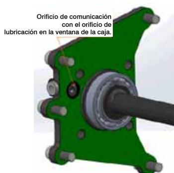
La placa también ofrece la posibilidad de llevar el aceite desde la caja hasta la toma a través de una manguera externa. En la parte exterior de la placa hay un tapón roscado G 1/4 que debe ser eliminado para la conexión de la manguera de lubricación forzada.
